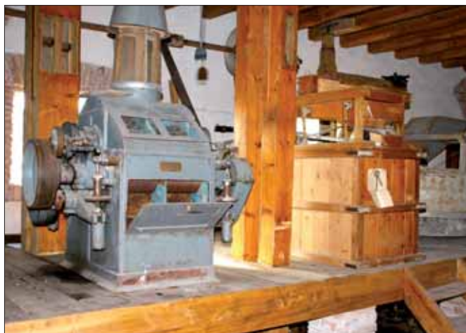
L'interno del mulino con a sinistra il molino a cilindri, al centro il vaglio e a destra le mole in pietra.
