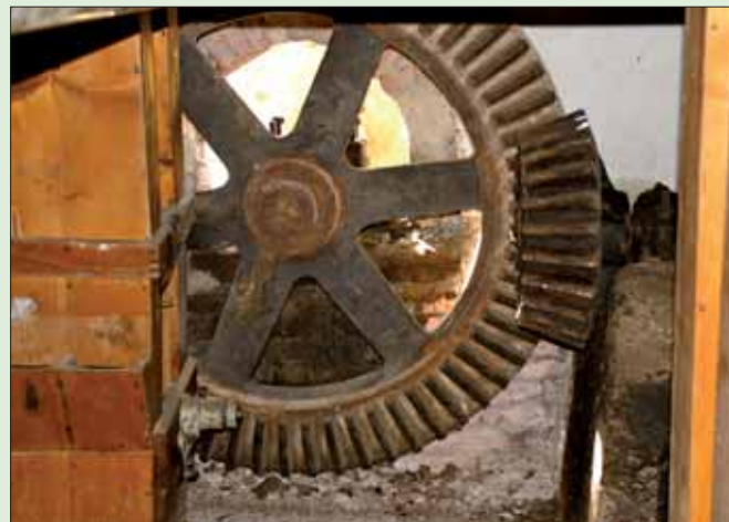
Particolare dell'ingranaggio principale con i denti in legno di acacia, e il piccolo tutto in ferro
