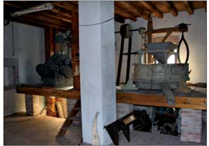
A destra sono ben visibili le mole con al centro la tramoggia e sotto la condotta di uscita della farina
